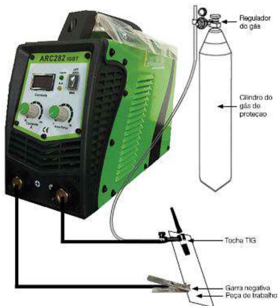
Figura 6.2: (b) Ligação dos cabos
