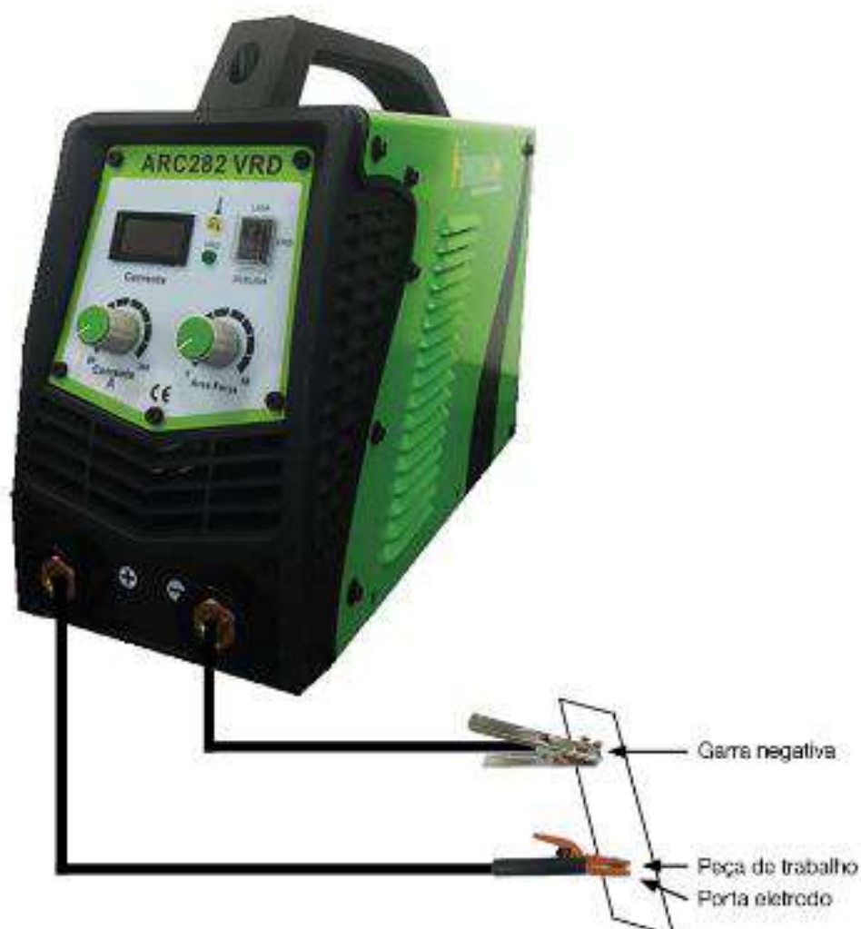
Figura 6.1: (a) Ligação dos cabos
