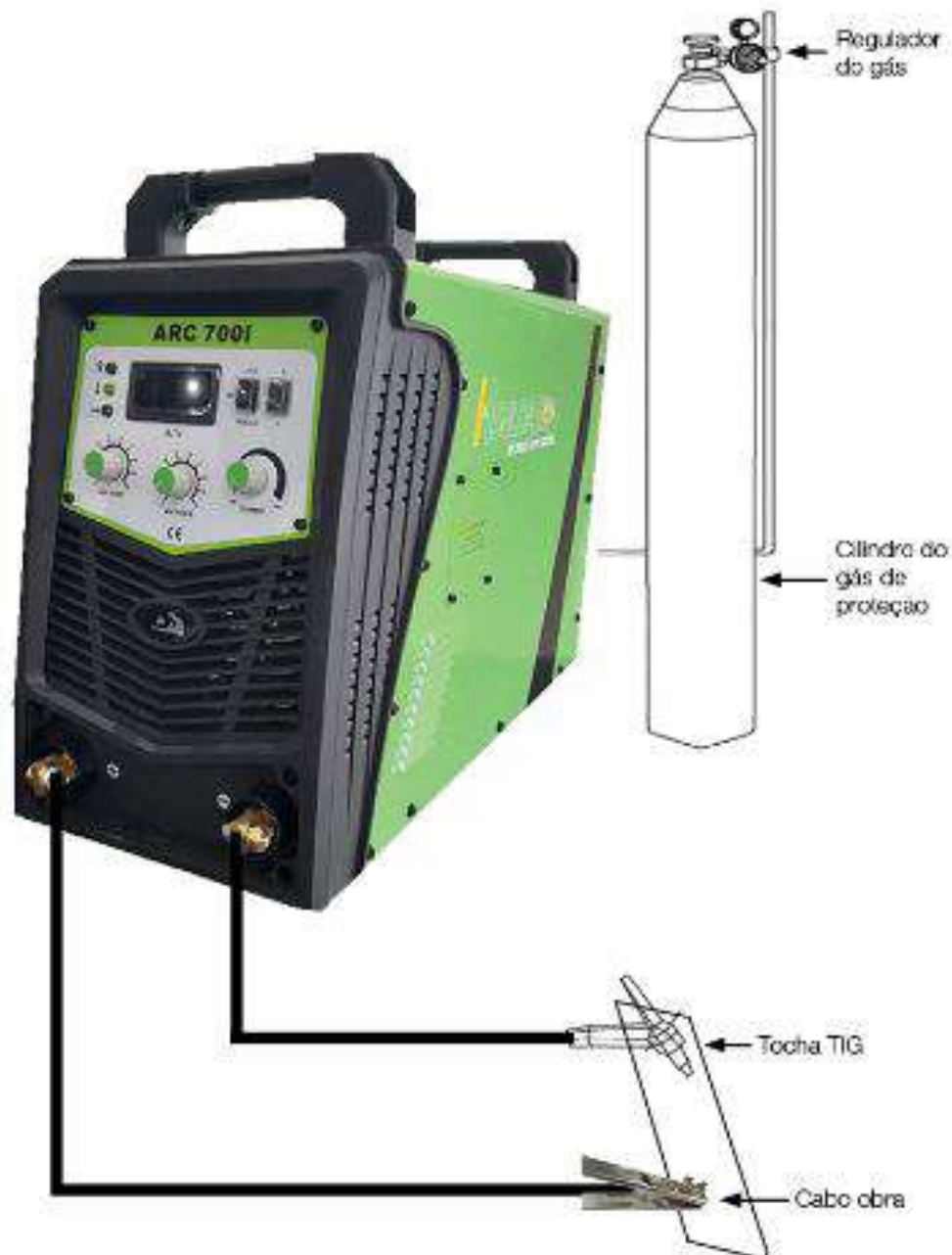
Figura 7.2: (b) Ligação dos cabos
