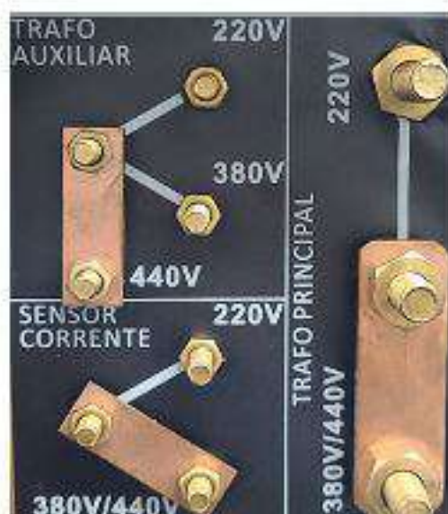
Figura 6.4: Fechamento para 440 V
