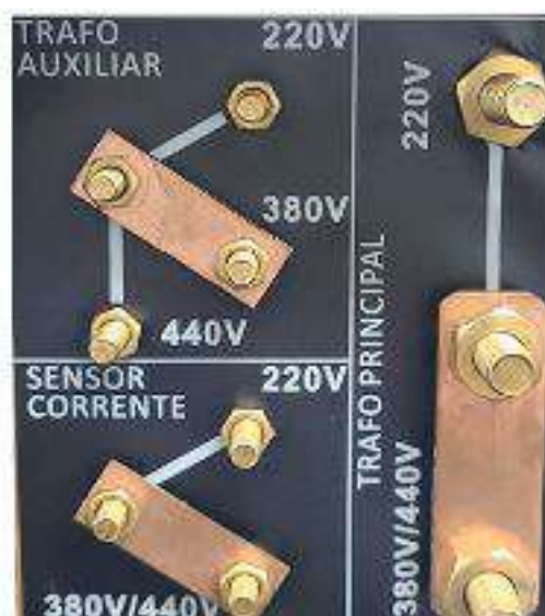
Figura 6.3: Fechamento para 380 V
