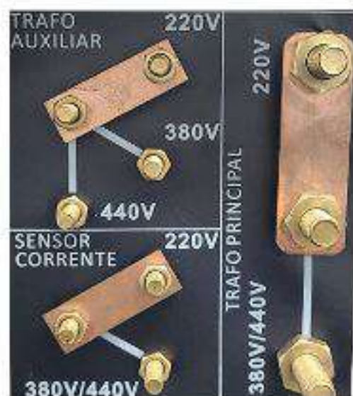
Figura 6.2: Fechamento para 220 V
